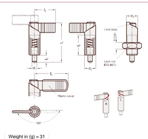
d1 = 6 d2 = M12x1.5 d3 = 12 l1 = 47 l2 = 8 l3 = 26 l4 = 26 l5 = 32
